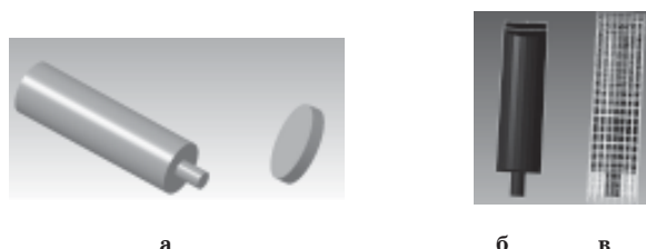
Рис.1. Моделі дослідної установки та її зображення у програмному комплексі FlowVision: а) циліндр з насадкою та поршень; б) завантажена модель з поршнем; в) задана розрахункова сітка.
