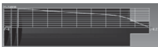
Рис.4. Графік зміни тиску вздовж осі дозувального циліндру
